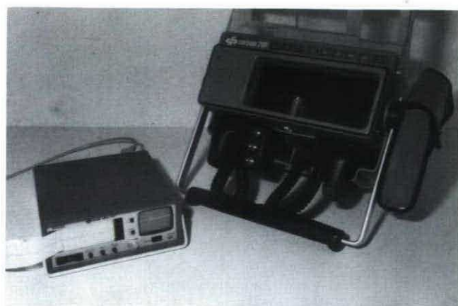
Corpuls met uigenomen en apart in gebruik zijnde monitor/schrijver.
